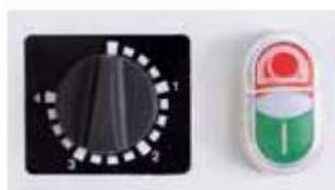
L'essoreuse ES 10 est équipée d'une minuterie de 1 à 4 minutes pour un **contrôle précis du temps** d'essorage.
